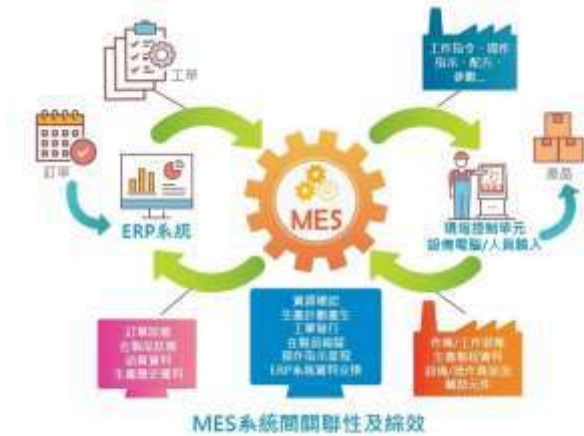
圖 9、ERP 與 MES 串接架構
