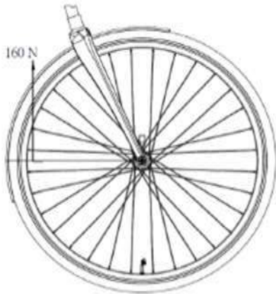
圖 1 — 前擋泥板 - 切線力測試
