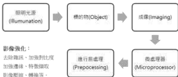
圖 15、影像前處理流程
