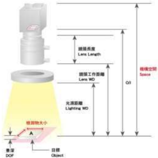
圖 17、相機整體規劃示意圖
