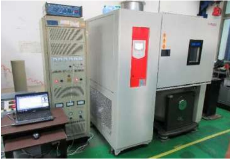
圖 7、恆溫箱與振動測試機複合環境測試
