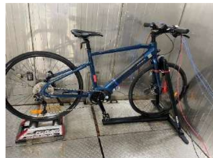
圖 4、電動輔助自行車恆溫箱測試圖示
