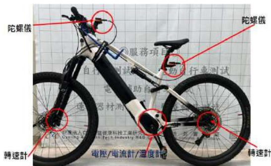
圖 11、車載偵測感測器布置
