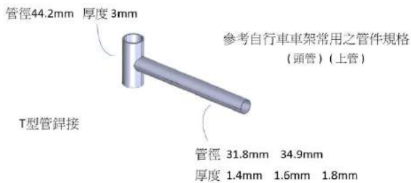
圖 41、T 型管規格尺寸
