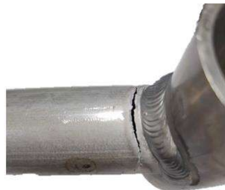
圖 45、T 型管靜力測試後斷裂情形
