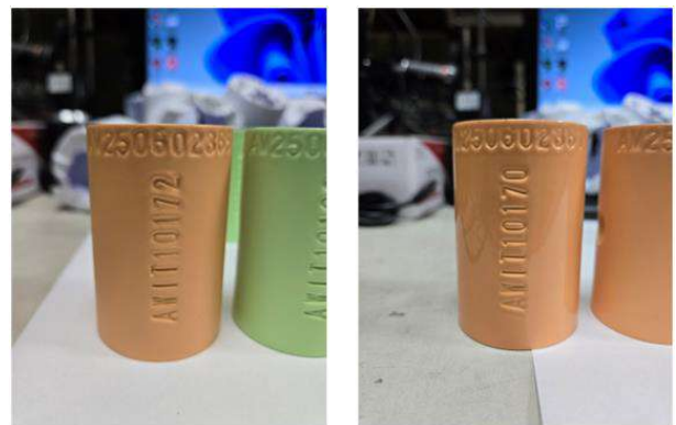
圖 13、五通管表面處理特性(左：消光、右：反光)
