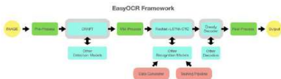
圖 6、EasyOCR 所使用的流程架構
