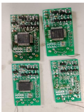
圖 3 小型化電路板設計及焊製
