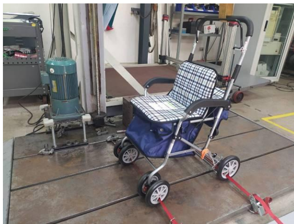
圖 4-1 折收機構之保持及強度測試
