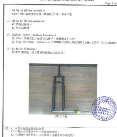
圖8 IP65 防護等級測試
