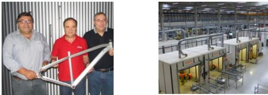
圖 2：葡萄牙公司 Triangles 發展之車架自動焊接生產線
