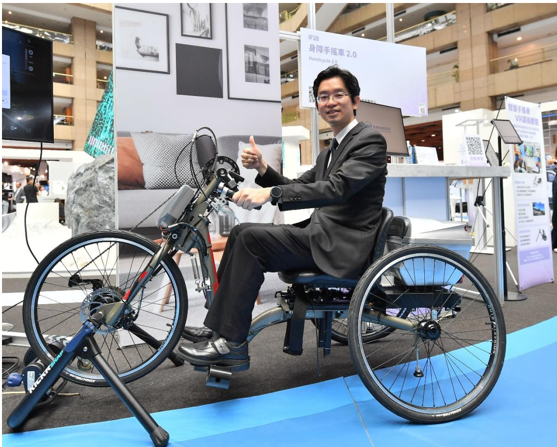
圖二、自行車中心「身障手搖車 2.0」導入電動輔助騎乘功能，並可以因應體能及心跳狀況，智慧化的調整輔助系統，用科技的方式幫助身障朋友享受健康生活、突破體能上的限制。圖為經濟部產業技術司簡任技正張能凱。
