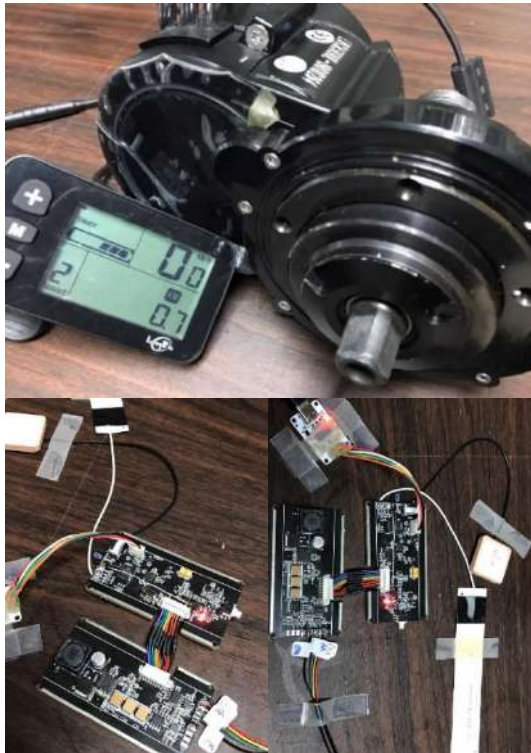
圖 5、聯網三電通訊測試
