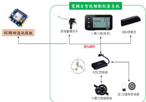
圖 1、電輔自智能驅動配套系統
