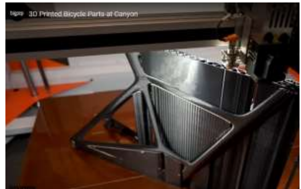
圖四、Canyon 設計自行車車架應用積層製造 (AM) 技術，省下的時間與成本。(圖片取自 https://www.youtube.com/@Bigrep3D )
