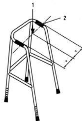
圖 1 助行器靜態負載測試
